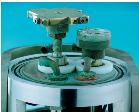
Bild 2: Kontaktanordnung des Funkenprüfgerätes nach IEC 60079-11
