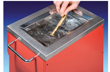
Neues Messgerät im Einsatz: Bestimmung der Reinigungswirkung von Ultraschallbädern
